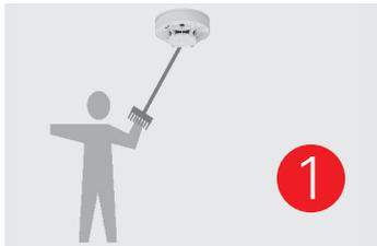
Drücken Sie **1 Sekunde** die Benutzer-Taste (z.B. unter zur Hilfenahme eines Besenstiels).
